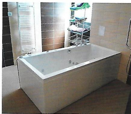
*V tomto domě je koupelna s vřívou vanou a zvedacím systémem Roomer, koupelna je přístupná ze dvou sousedících pokojů, a právě zvedacím systémem je možné imobilního klienta snadno přemístit z lůžka do vany a zpět.*
